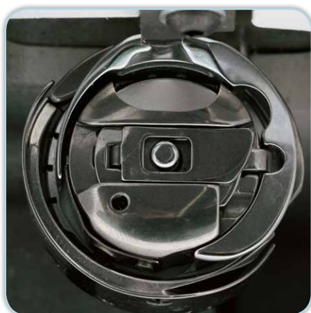
Robuster Doppelumlaufgreifer mit großer Fadenspule
