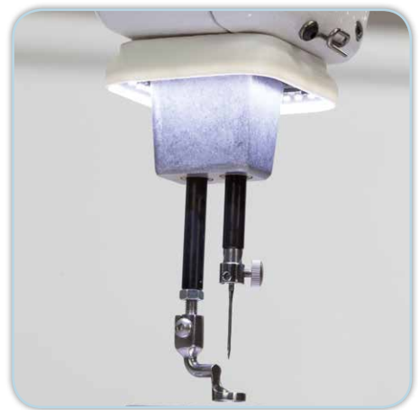
LED-Lichtring im Nadlebereich, warmes, kaltes, neutrales, UV-Licht
